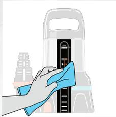
2. Stecke die Pumpe aus, nimm sie aus dem Wasser und trockne die Sensorfläche
