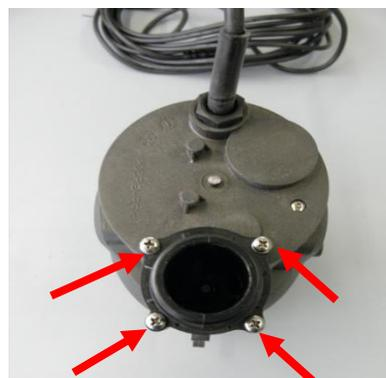
Der Anschlussadapter ist mit 4 Kreuzschlitzschrauben fixiert. Nach dem Entfernen der Schrauben kann der Adapter durch kräftiges Ziehen abgenommen werden.
