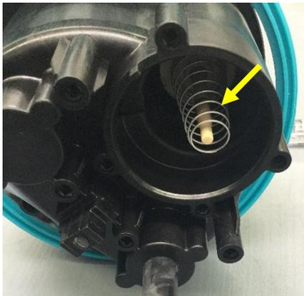
Das Rückschlagventil kann entnommen und gereinigt bzw. ausgetauscht werden. Am Rückschlagventil sollte die Dichtung und Führung sowie der Magnetring gereinigt werden
