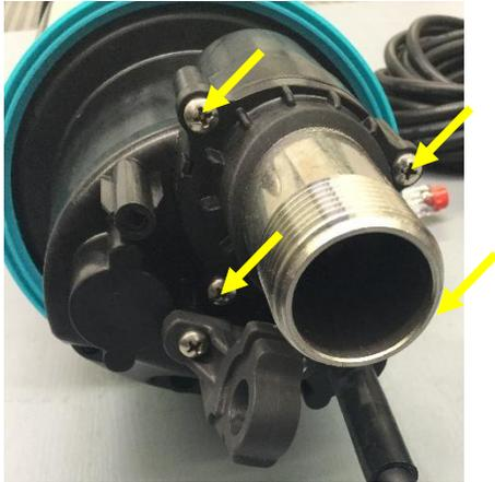
Der Anschlussadapter ist mit 4 Kreuzschlitzschrauben fixiert. Nach dem Entfernen kann der Adapter durch kräftiges Ziehen abgenommen werden.
