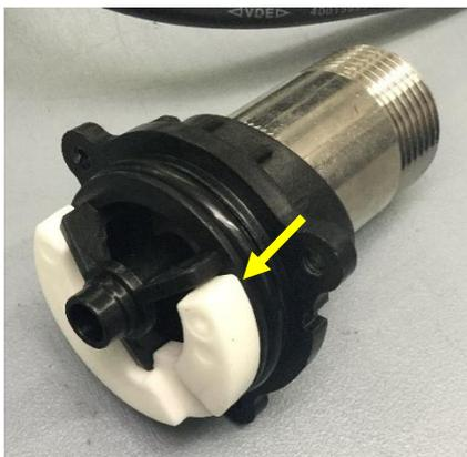
Die Position des Druckkompensator für den Zusammenbau wie im Foto links aufgeführt.
