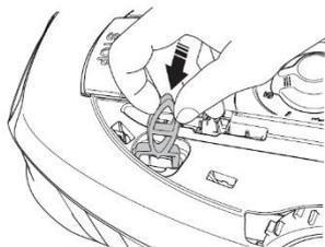
1. Sie können zusätzlich auch das Gehäuse des Mähroboters demontieren. Hierzu empfehlen wir die Verwendung des Spezialwerkzeugs Art. 59-32.156.01, welches Sie direkt bei uns bestellen können.
