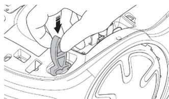
3. Lösen Sie nun mit dem Spezialwerkzeug das Gehäuse von den Aufnahmen (4 Stück).
