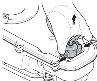
Das schwenkbare Hinterrad demontieren Sie, indem Sie die zwei Klammern gleichzeitig nach innen drücken. Ziehen Sie das Hinterrad nach oben hinaus.
