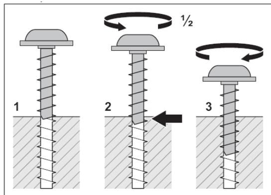
**Kleiner Tipp um die Gewinde in den Plastikteilen nicht zu beschädigen**
