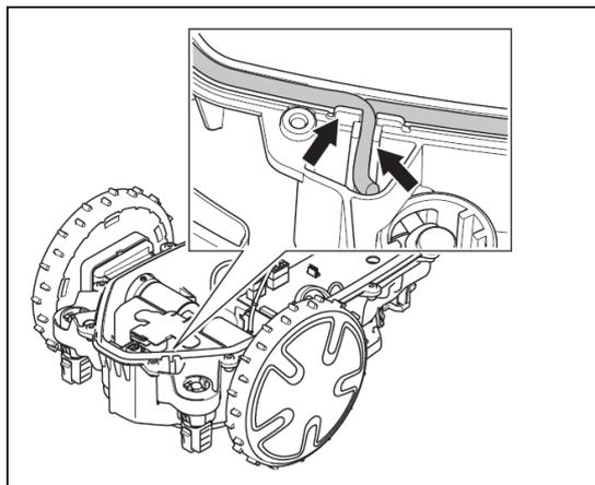
**Achten Sie auf eine ordnungsgemäße Verlegung des Dichtbandes da sonst eine Undichtigkeit die Folge sein kann und der Mähroboter kann beschädigt werden.**
