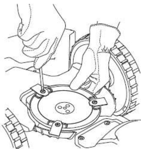
Der Mähroboter verfügt über drei beweglich gelagerte Klingen, die in den Messerteller eingeschraubt sind. Alle drei Klingen und Schrauben müssen bei Bedarf gleichzeitig ausgetauscht werden, damit das Mähsystem richtig ausgewuchtet ist.
