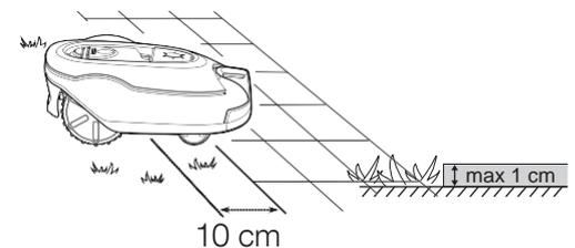
Wenn der Arbeitsbereich durch einen Weg mit Steinpflaster auf gleicher Ebene wie der Rasen getrennt wird, ist der Mähroboter in der Lage, auch über den Weg zu fahren. Es kann sogar von Vorteil sein, das Begrenzungskabel unter dem Steinpflaster zu verlegen. Das Begrenzungskabel kann auch zwischen den einzelnen Steinen des Pflasters verlegt werden. Stellen Sie sicher, dass die Fliesen auf der gleichen Höhe mit dem Rasen sind, um übermäßigen Verschleiß des Mähroboters zu verhindern.
