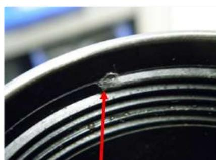
Gewindeansatz beschädigt. Gewinde durch eingedrehten Anschlag des Filterdeckels deformiert.
