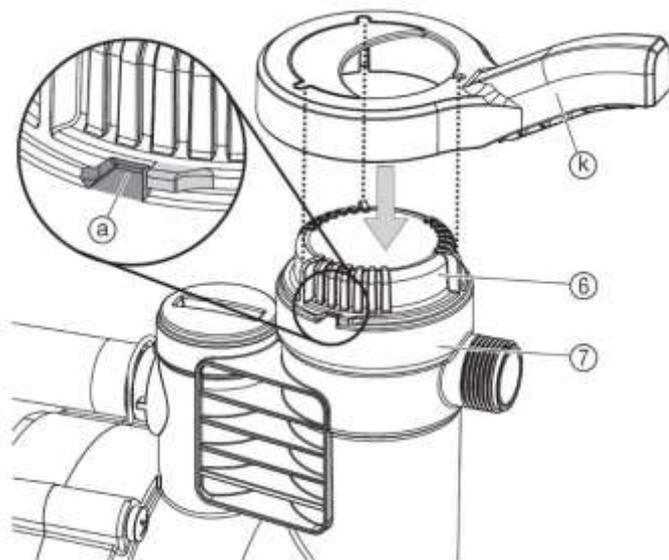
1. Deckel (6) am Einfüllstutzen (7) aufdrehen / zudrehen
